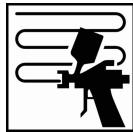
Нанесите один тонкий слой грунта-изолятора Sealer Plus и дайте выдержку как минимум 15 минут при 20°C.
