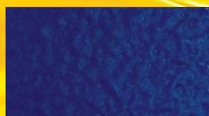
GRAVHEL покрытие полиуретановое структурное 430, МИКС RAL 5017 и GRAVHEL паста 23, HVLP 1,7 мм
